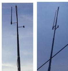
**Gambar 17.**Antena Penerima data ADS-B dari Transponder
