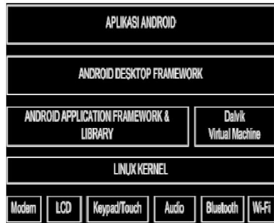
Gambar 1. Lapisan arsitektur sistem operasi android
