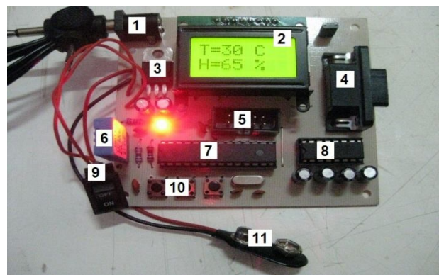
Gambar 6. Purwarupa Perangkat Akuisisi Data Portabel
