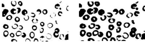
(c) (d) Gambar 12. (c) Erosi (d) Dilasi
