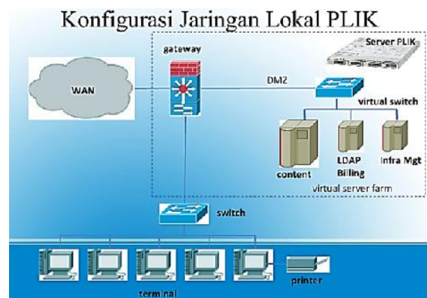
Gambar 1. Konfigurasi Jaringan PLIK (Sumber : www.slideshare.net , [8])
