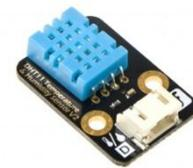
Gambar 3. Sensor DHT11
