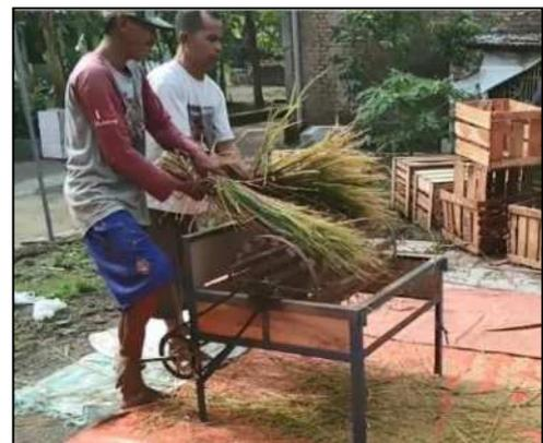
**Gambar 2. Mesin Perontok Padi Manual (dengan Pedal)**
