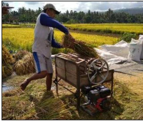
**Gambar 3. Mesin Perontok Padi Modern (dengan mesin diesel)**
