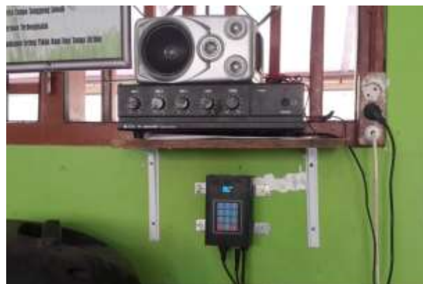
Gambar 10. Pengaplikasian Bel Sekolah Menggunakan Arduino Pro Mini dan Pengeras Suara yang Tersedia
