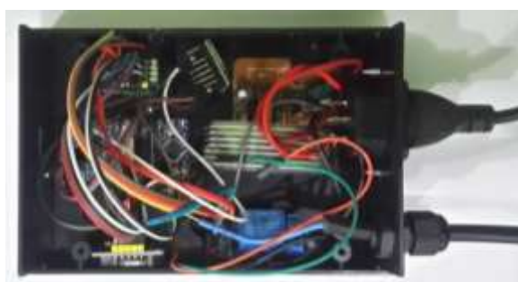
Gambar 9. Arduino Pro Mini dan Rangkaian Modul Bel Otomatis Sekolah
