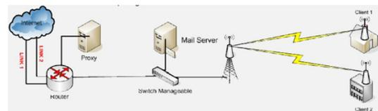
Gambar 2 Topologi Setelah Pemasangan Server
