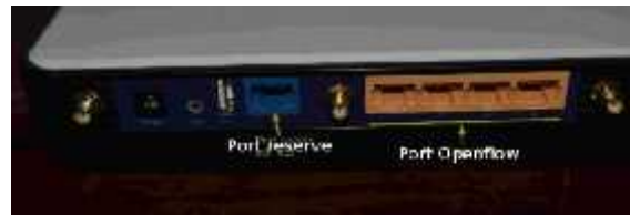
Gambar 4. Port pada switch yang telah dirubah firmware-nya
